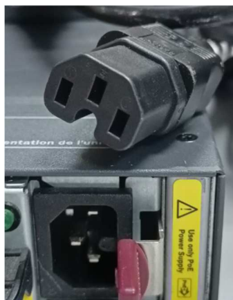
Ilustración 22. Ejemplo de un conector singular de alimentación
